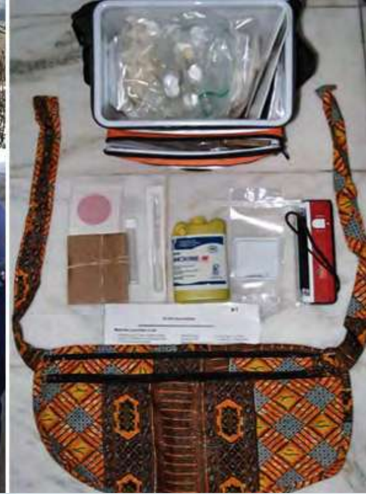
مجموعة أدوات اختبار قابلة للارتداء تقدم طريقة يسيرة سهلة لاختبار وجود الإشريكية القولونية في مياه الشرب. صورة: سوزان مركوت/ معمل-D في معهد ماساتشوستس للتكنولوجيا (MIT)
